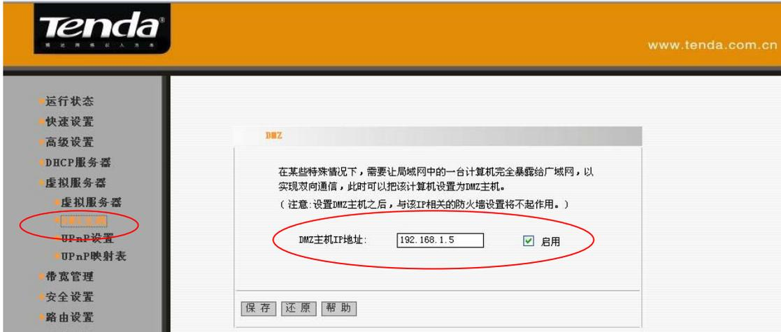
DMZ 主机 IP 地址为数据库服务器所在局域网内的 IP 地址, 将[启用]项打上勾。
